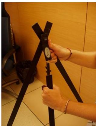
1. Montaje de la base. Abrir las patas e insertar la varilla central.
